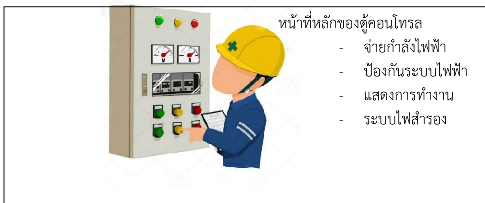
ภาพที่ ๑๒ ตู้คอนโทรล (Electrical control Box)
