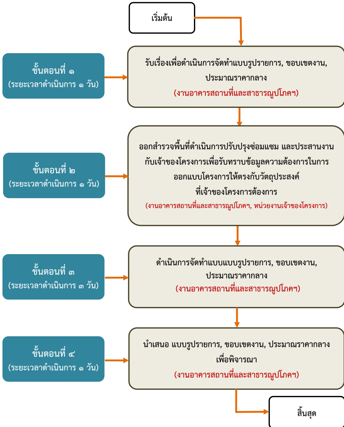
ภาพที่ ๖ ขั้นตอนการออกแบบโครงการปรับปรุงซ่อมแซมอาคาร
