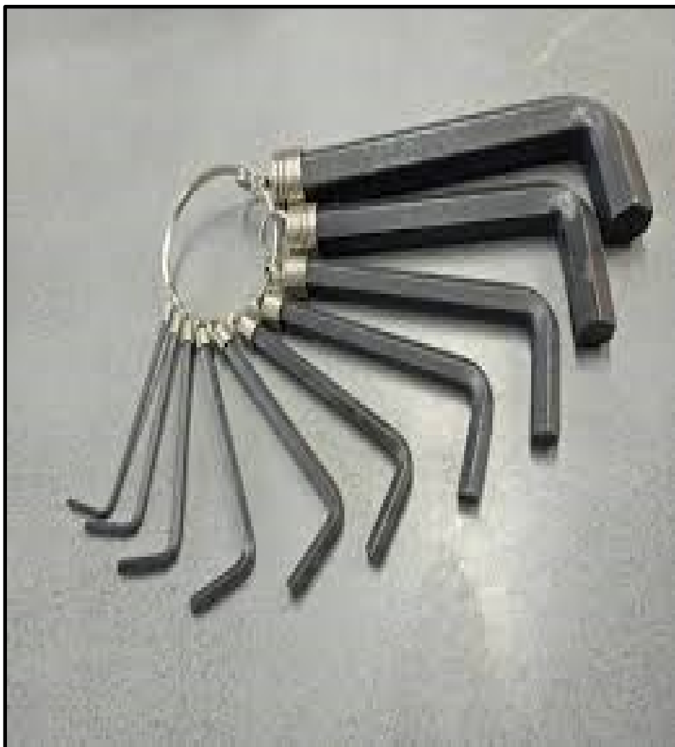
ภาพที่ ๑๘ ภาพกุญแจหกเหลี่ยมที่ใช้ในการขันน็อตยึดฝา COP
