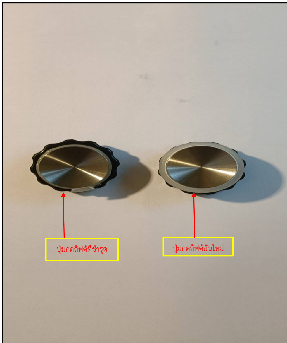
ภาพที่ ๒๔ ภาพปุ่มกดภายในห้องลิฟต์โดยสาร
