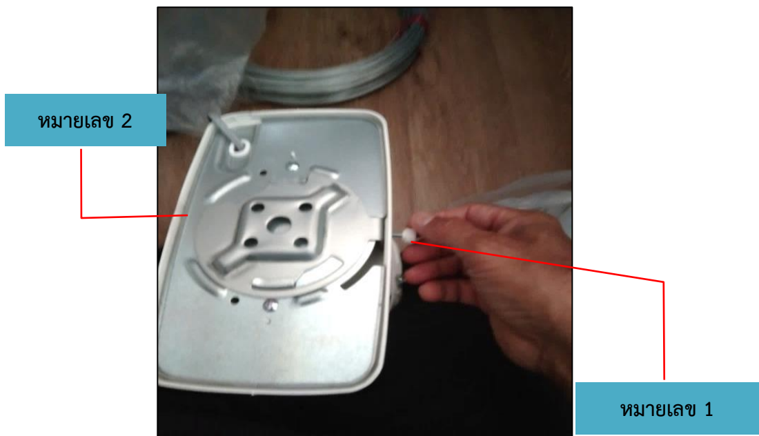
ภาพที่ 3.42 การถอดฐานยึดพัดลมโคจร
